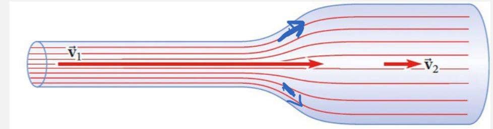
In un condotto a sezione variabile, vediamo le linee di flusso più ravvicinate dove il fluido scorre più velocemente
