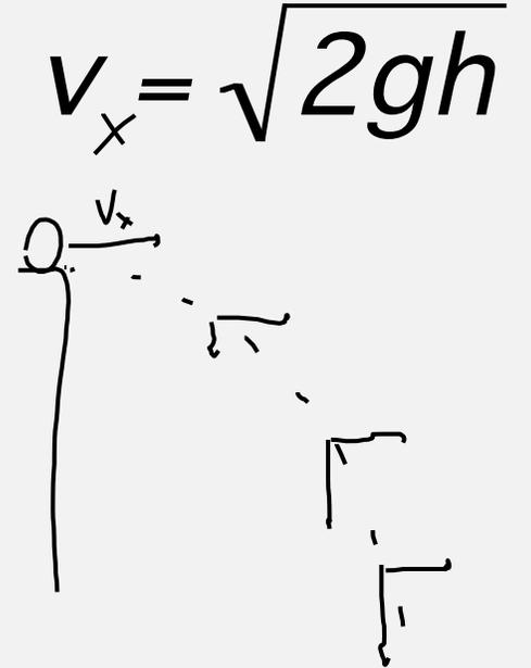
Il fluido esce con velocità orizzontale  $v_b$  e poi segue il moto parabolico:
