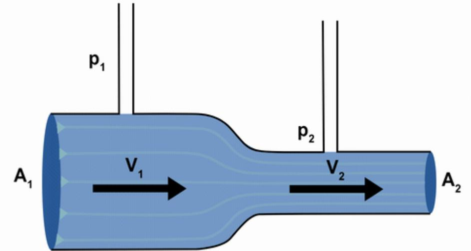
La pressione del fluido nella strozzatura ( $P_2$ ) non può essere uguale a quella prima o dopo la strozzatura ( $P_1$ ) → nel caso di un flusso orizzontale, la velocità è maggiore dove la pressione è minore → **EFFETTO BERNOULLI / PRINCIPIO DI BERNOULLI**
