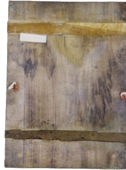
Asse unica con traversa superiore in pioppo e inferiore in castagno
