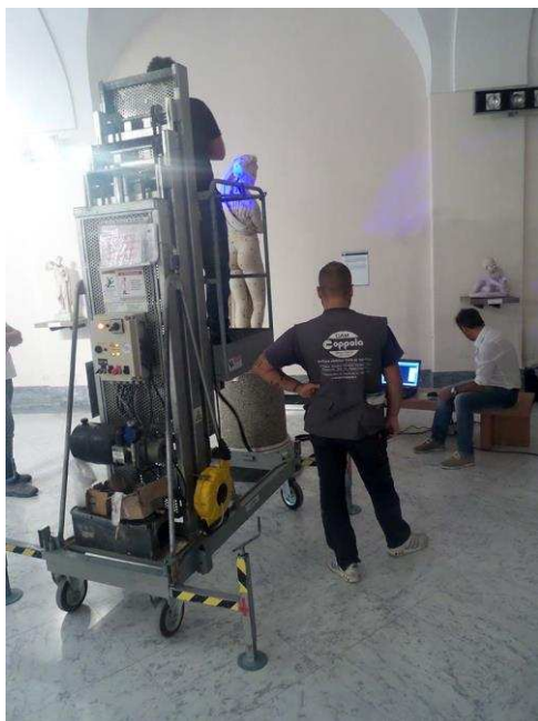
Fig. 1 - Una visione del cantiere di rilevazione. La piattaforma elettrica presente nel MANN ha sostituito il braccio estensibile orbitante. La presenza e la ricchezza dei sottosquadri ha richiesto l'abilità manuale dell'operatore per cogliere la complessità plastica dell'opera.
