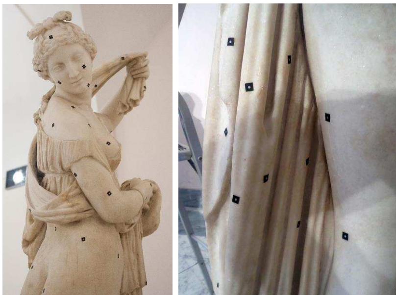
Fig. 3 - Sull'opera vengono distribuiti target di riferimento della misura secondo un solido di proiezione che sia in grado di dare risposte utili per creare una nuvola di punti tridimensionali. I target hanno un adesivo tixotropico che per leggera pressione aderiscono al materiale e successivamente se ne distaccano senza, di fatto, trasferire alcuna sostanza al materiale costitutivo dell'opera.
