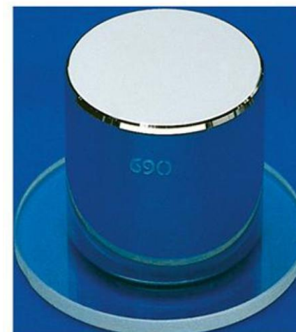
Figura 1.3 Il riferimento standard internazionale della massa di 1 kg, un cilindro di platino-iridio di diametro e altezza entrambi pari a 3,9 cm.
