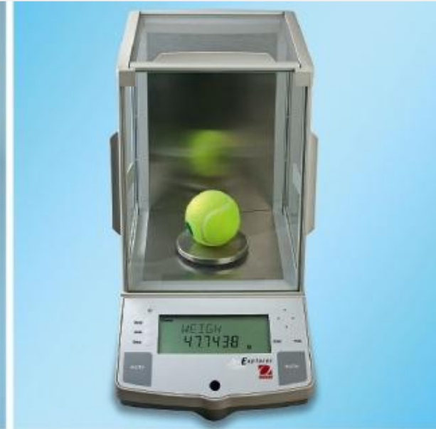
Bilancia per uso analitico sensibilità 0,0001 g
