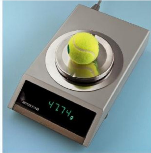
Bilancia di laboratorio sensibilità 0,01 g
