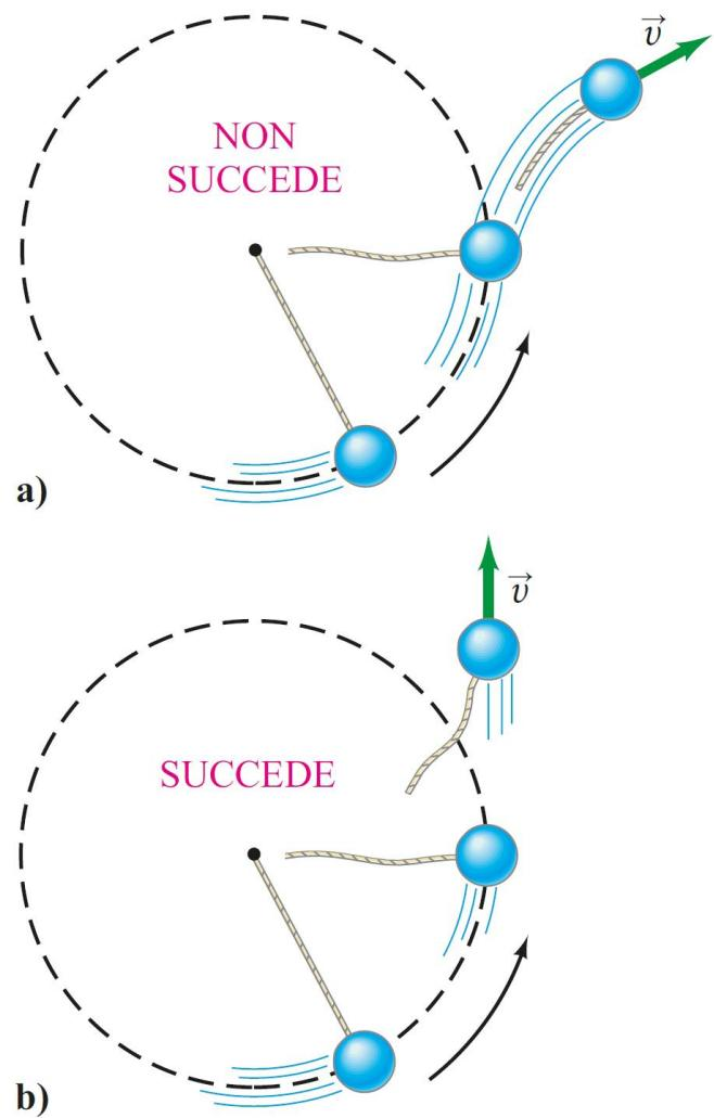
**Figura 5.16** Se esistesse una forza centrifuga, la pallina dovrebbe muoversi verso l'esterno come in a), una volta lasciata libera. In realtà, si allontana dalla traiettoria originaria, proseguendo in direzione tangenziale alla circonferenza come in b). Per esempio, in c) le scintille prodotte da una mola in rapida rotazione vengono proiettate lungo linee rette tangenti al bordo della mola.
