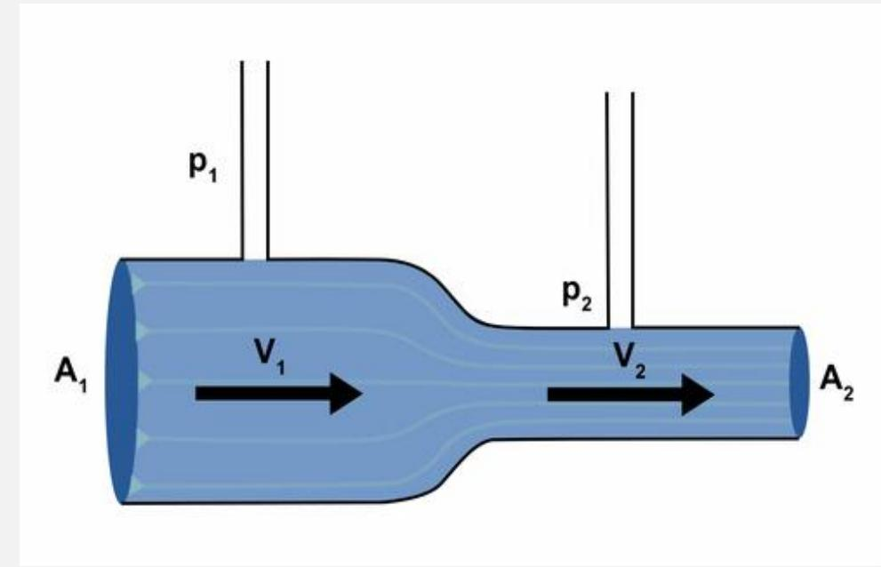
La pressione del fluido nella strozzatura (P2) non può essere uguale a quella prima o dopo la strozzatura (P1)  $\rightarrow$  nel caso di un flusso orizzontale, la velocità è maggiore dove la pressione è minore  $\rightarrow$  **EFFETTO BERNOULLI / PRINCIPIO DI BERNOULLI**
