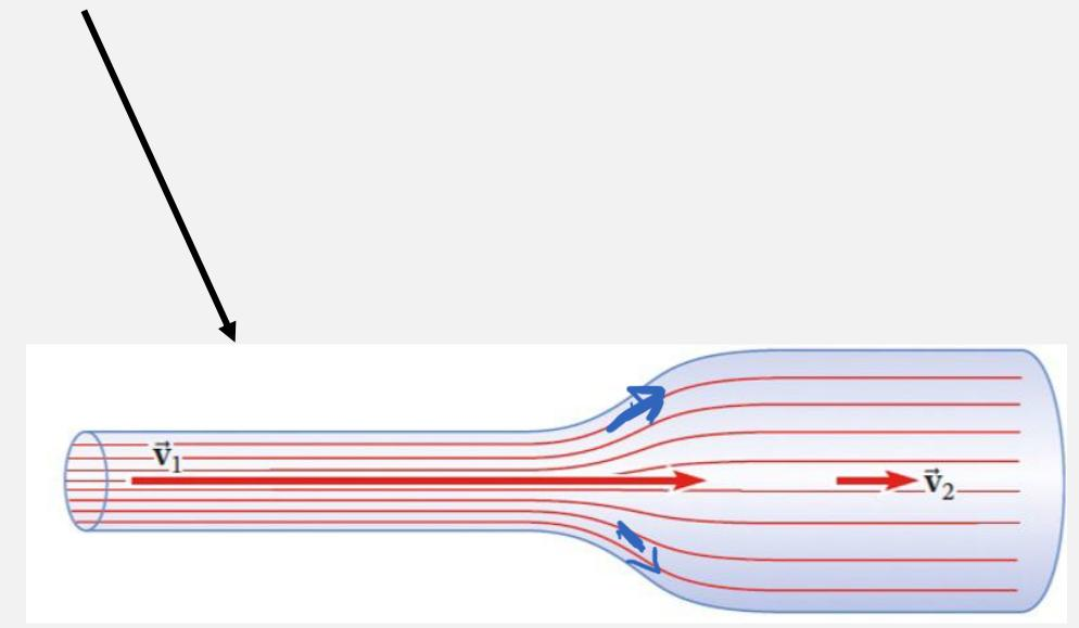
In un condotto a sezione variabile, vediamo le linee di flusso più ravvicinate dove il fluido scorre più velocemente
