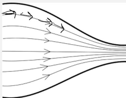
**STAZIONARIO:** moto stazionario, ovvero la velocità del fluido in ogni punto è costante nel tempo. Anche densità e pressione del fluido sono costanti.
