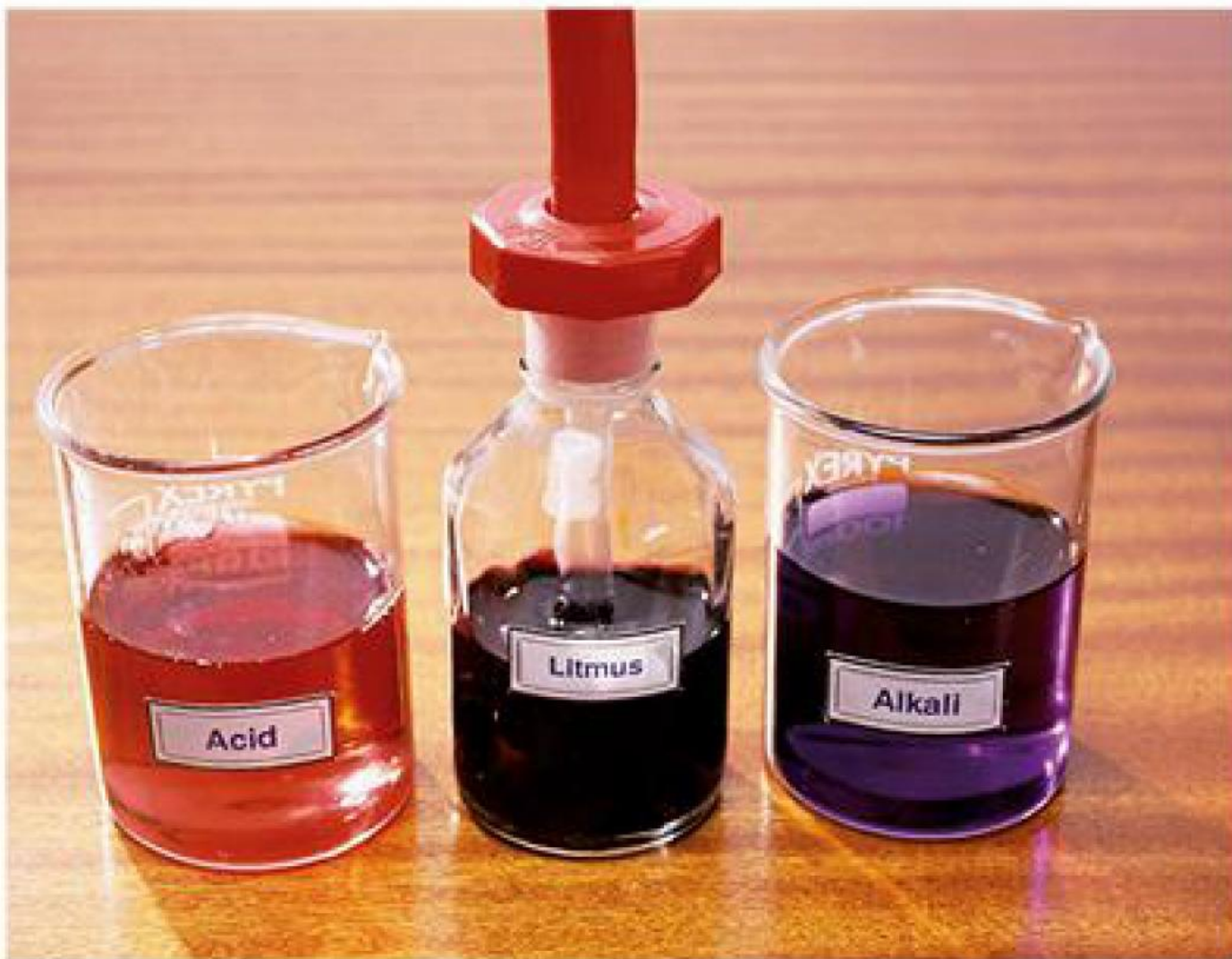
Figura 9.1 Il tornasole (litmus) colora in rosso una sostanza acida e in blu una sostanza basica.
