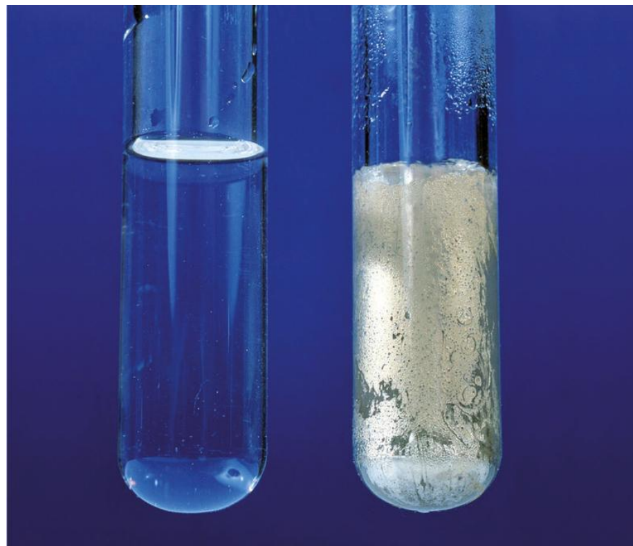
Figura 14.1 Nel test di Tollens l'ossidazione di un'aldeide operata da ioni \text{Ag}^+ produce un caratteristico strato di argento metallico che si deposita sulle pareti della provetta.
