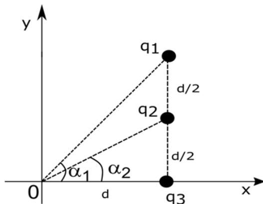
Tre cariche puntiformi  $q_1$ ,  $q_2$  e  $q_3$  sono tenute ferme nella configurazione riportata in figura. Le cariche valgono:  $q_1 = q_3 = 3.20 \cdot 10^{-19}$  C mentre  $q_2 = -q_1$ . La distanza  $d = 2$  cm e l'angolo  $\theta = 45^\circ$  (vedi figura). Calcolare Il modulo del campo elettrico  $E$  all'origine degli assi  $O$  ad opera di tutte le cariche.
