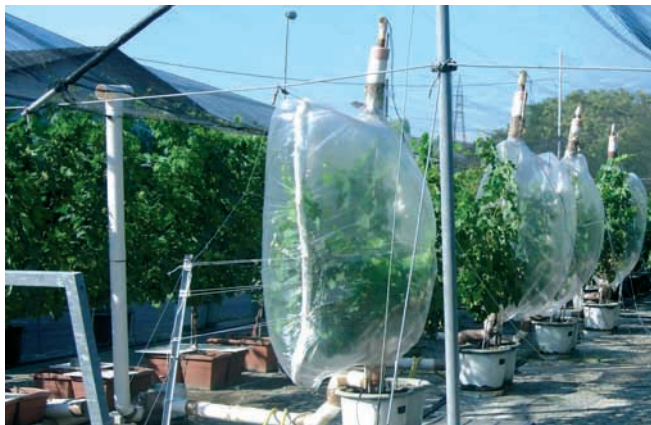
Fig. 8 - Panoramica di un sistema di monitoraggio di scambi gassosi della chioma su vite. Foto S. Poni.
