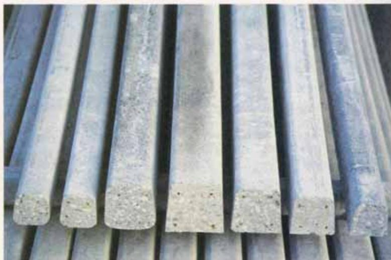
Foto 11 - Nel caso sia ipotizzabile la vendemmia meccanica l'eventuale palo di cemento deve essere del tipo precompresso e con spigoli arrotondati (foto A. Morando).
