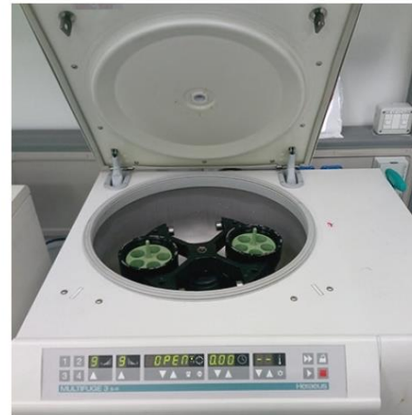
Centrifuga refrigerata con rotore a bracci oscillanti
