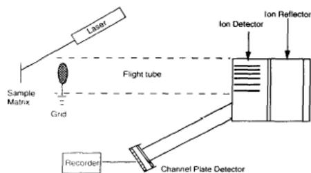
Laser più utilizzati: laser che emettono nel lontano IR e nel lontano UV con ampiezze d'impulso tra 1 e 100 ns per ridurre la decomposizione termica.
