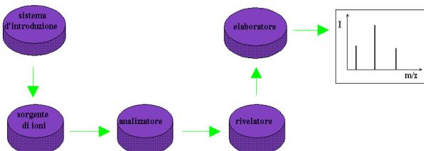
Il campione, immesso nello spettrometro dal dispositivo d'introduzione viene ionizzato nella sorgente dando luogo ad un fascio di ioni positivi o negativi che vengono separati dall'analizzatore di massa in funzione al rapporto  $m/z$  e rivelati da un detector che trasforma il fascio ionico in un segnale elettrico; quest'ultimo viene registrato ed elaborato da un computer in uno spettro di massa
