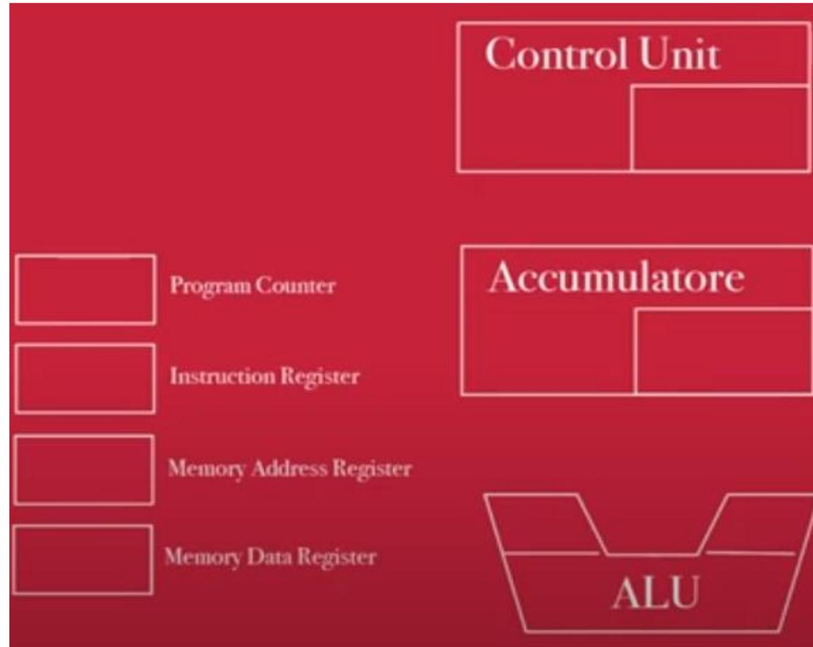
Program Counter = Registro contatore      Instruction Register = Codice dell'istruzione da eseguire
