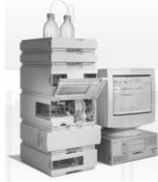
Vengono usate colonne impaccate con piccole particelle, in grado di operare a pressioni 1000-3000 psi
