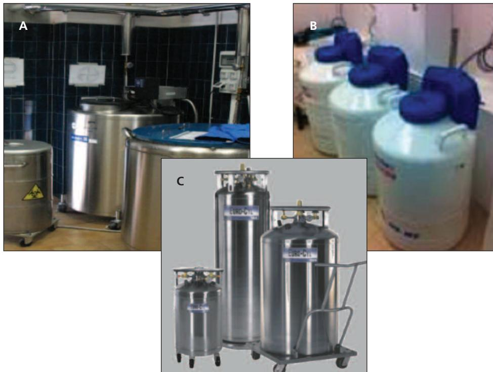
**Fig. 3 A, B, C.** Diverse tipologie di contenitori Dewar per lo stoccaggio in azoto liquido.
