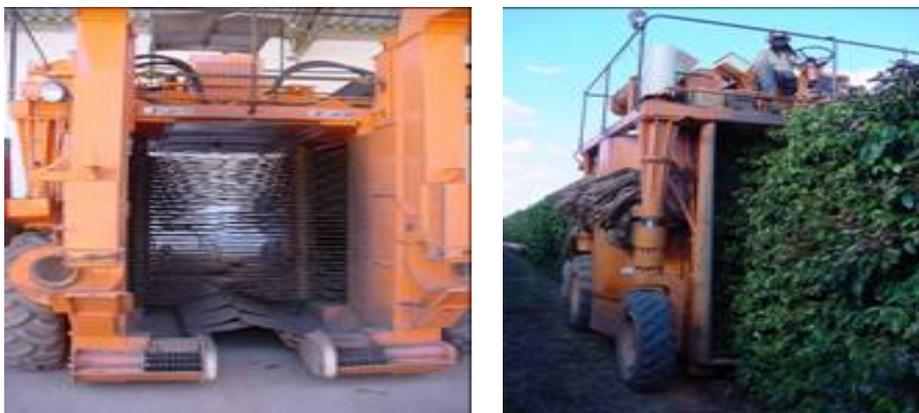
**Figura 7.** Macchina e suo impiego per la raccolta di caffè
