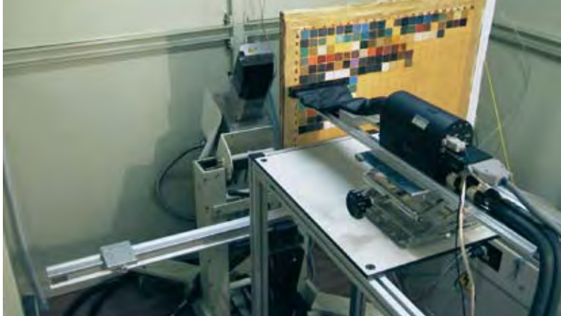
8. Un prototipo di sistema a scansione per radiografia. Per gentile concessione di Franco Casali, Università di Bologna.
