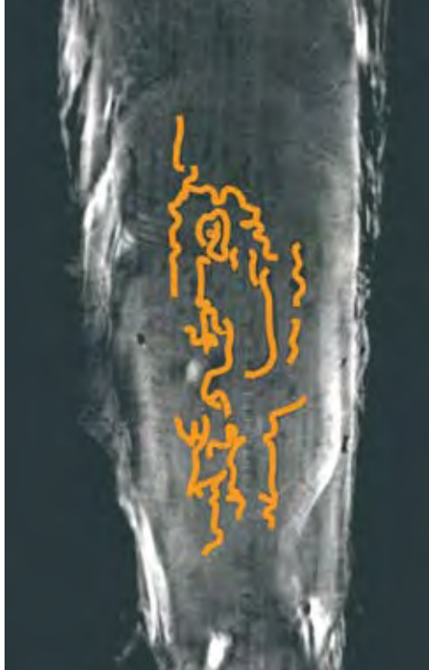
3. Tomografia computerizzata del verso dell'opera precedente con indicate le gallerie dei tarli come riconosciute dallo studio delle sezioni CT longitudinali. Per gentile concessione di Franco Casali, Università di Bologna, e della Pinacoteca Nazionale di Bologna.
