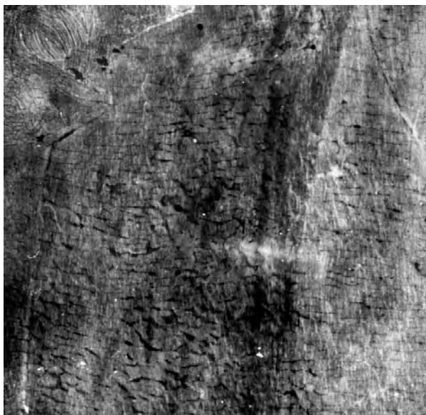
13. Dettaglio radiografico di una tavola di fine Quattrocento. Le lesioni sono visibili come zone più scure, meno radiopache.
