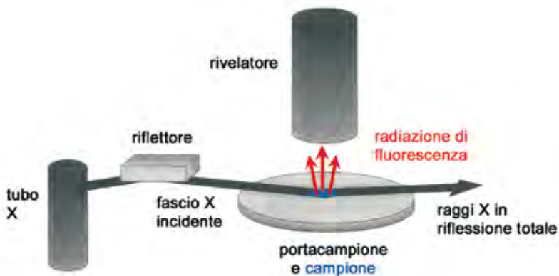
1. Schema di una strumentazione per TXRF.
