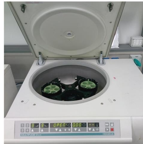
Centrifuga refrigerata con rotore a bracci oscillanti
