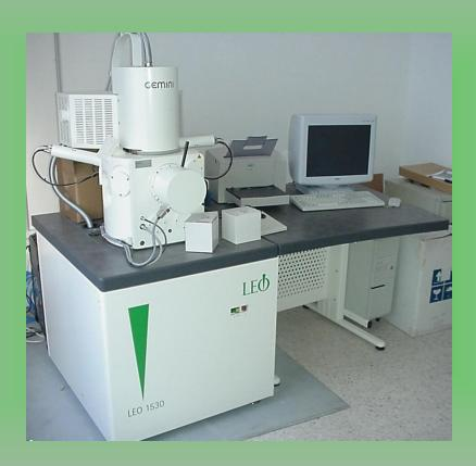
Nel SEM l'oggetto sul quale vengono proiettati gli elettroni è costituito dalla superficie libera di una o più cellule di un frammento d'organo preventivamente ricoperte da una sottile pellicola di metallo.
