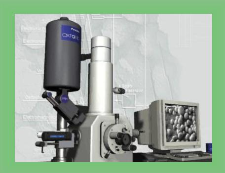
Il SEM permette l'esame di estese superfici libere fornendo immagini di facile lettura. Ha la limitazione di un potere di risoluzione che raggiunge 1 nm (a 20 kV) oppure 3 nm (ad 1 kV) contro valori di 0,2 nm raggiungibili con il TEM.
