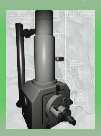
Gli elettroni emessi dal catodo vengono deflessi da un semplice sistema di lenti elettromagnetiche poste, come il campione in condizioni di vuoto spinto, condizione necessaria ad evitare distorsioni del fascio.
