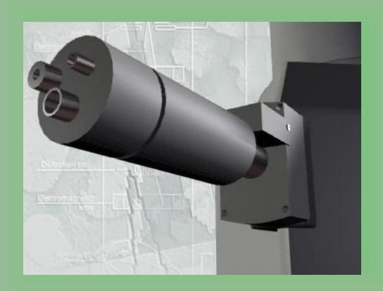
La superficie metallica bombardata dagli elettroni diventa una sorgente di elettroni secondari che, emessi in quantità e direzioni diverse, vengono raccolti da due diversi detectors e trasferiti alla griglia di controllo di un oscilloscopio a raggi catodici che li devia sullo schermo.
