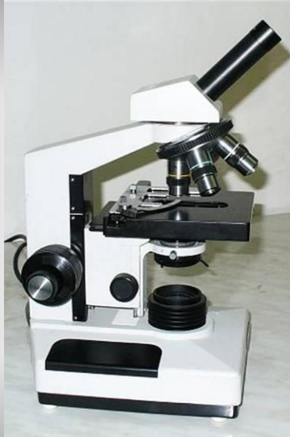
Ancora oggi i microscopi ottici composti a luce trasmessa costituiti da più **lenti convergenti** sono quelli più largamente utilizzati in biologia.
