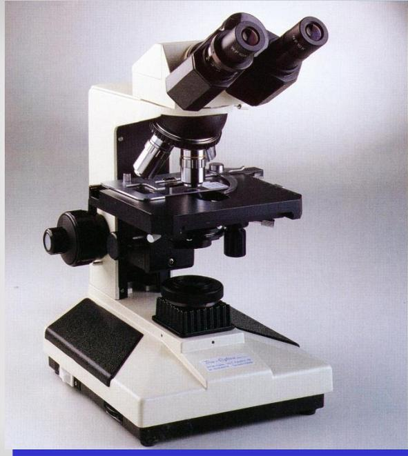
L'oculare o gli oculari sono applicati sul tubo portaottica a distanza fissa dall'obiettivo. Possono essere inclinati rispetto all'asse dell'obiettivo mediante l'interposizione di un prisma. Così anche l'interposizione di più prismi consente lo sdoppiamento del fascio di luce proveniente dall'obiettivo su due oculari distinti.
