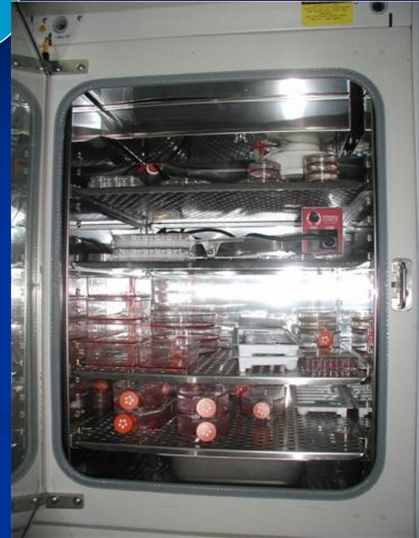
Un incubatore per colture cellulari garantisce la stabilità di alcuni parametri necessari per coltivare le cellule *in vitro*.
