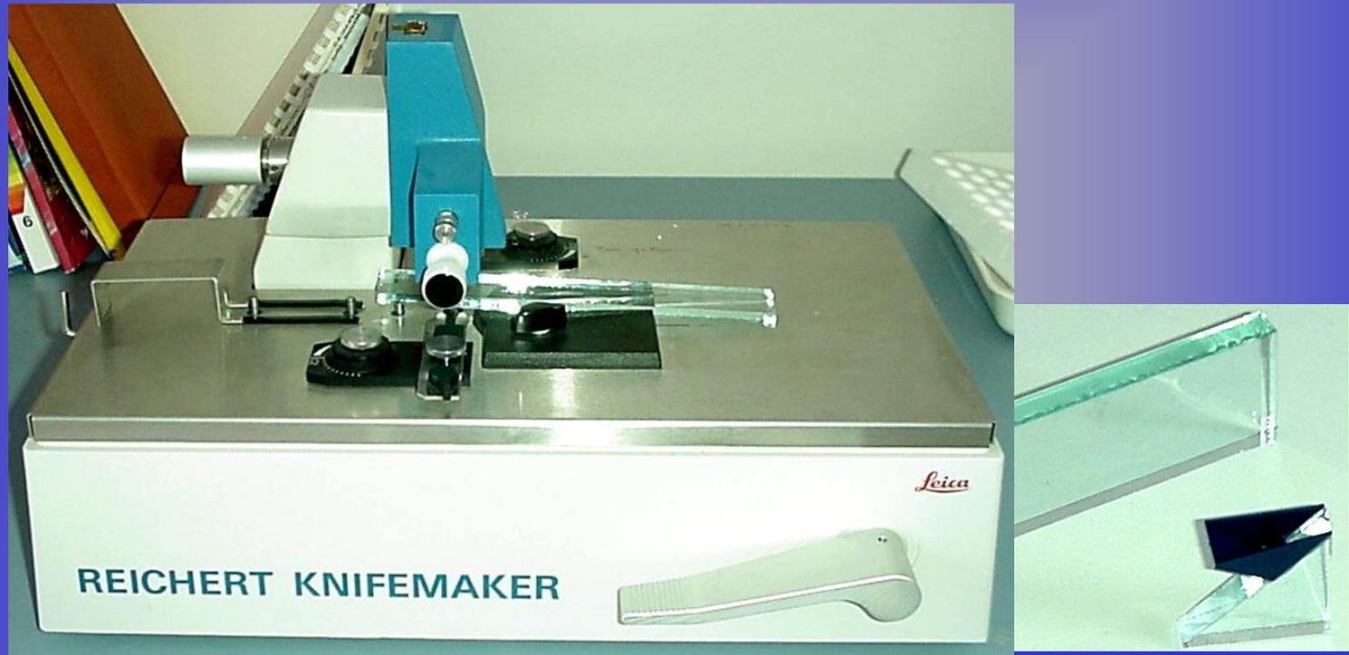
La preparazione delle lame di vetro richiede l'utilizzo del **knifemaker**, un particolare "taglialame" che consente di ottenere lame con inclinazioni strettamente legate al tipo di tessuto da trattare.
