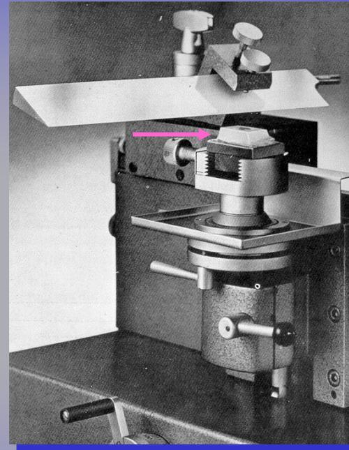
Il blocchetto di tessuto incluso viene fissato entro un supporto collegato ad un meccanismo in cui è possibile lo spostamento micrometrico rispetto ad una lama di metallo.
