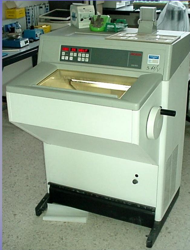
Per il taglio dei pezzi fissati con congelamento viene utilizzato un particolare microtomo che differisce dai comuni microtomi in quanto il campione da sezionare e la lama di taglio vengono entrambi raffreddati in una camera termostata a valori variabili da  $-18^{\circ}$  -  $25^{\circ}$  in modo da mantenere una maggiore consistenza del campione .
