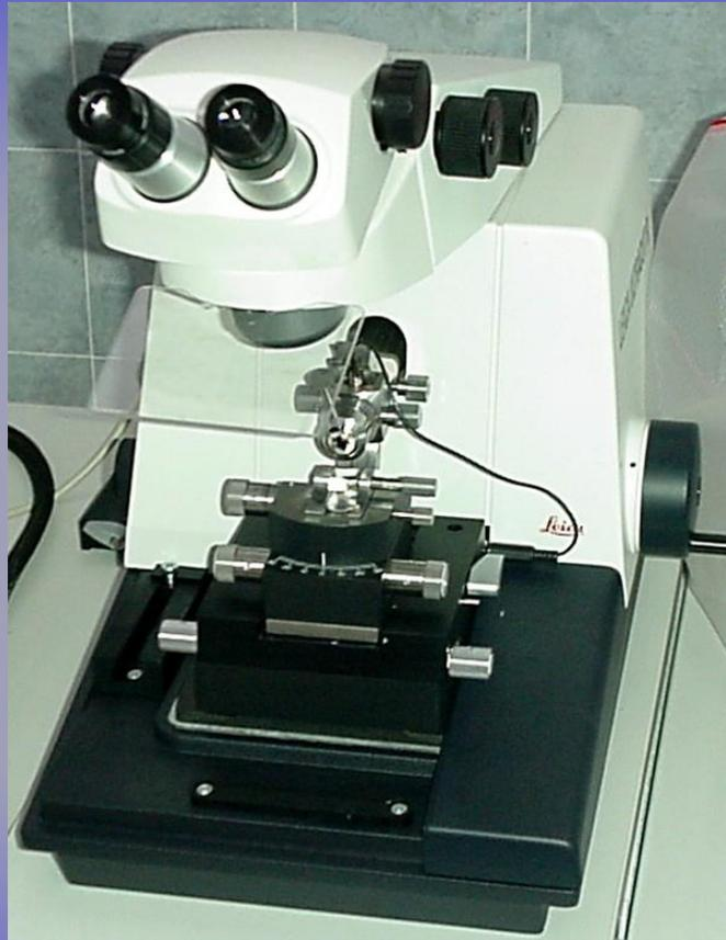
Per l'osservazione ultrastrutturale i campioni inclusi in resine epossidiche o acriliche dovranno essere sezionati con un ultramicrotomo a spessori variabili dai 20 ai 200 nm. Esso è dotato di uno stereomicroscopio per ingrandire opportunamente i preparati da sezionare che sono normalmente assai piccoli.
