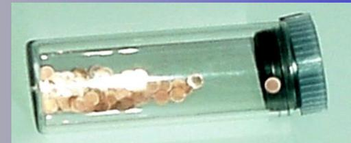
Le retine metalliche o **grids** possono essere di rame o, in caso di indagini immunocitochimiche, di nickel o oro. La loro forma e la compattezza delle **bar** varia a seconda del tipo di osservazione e si misura in **mesch**.
