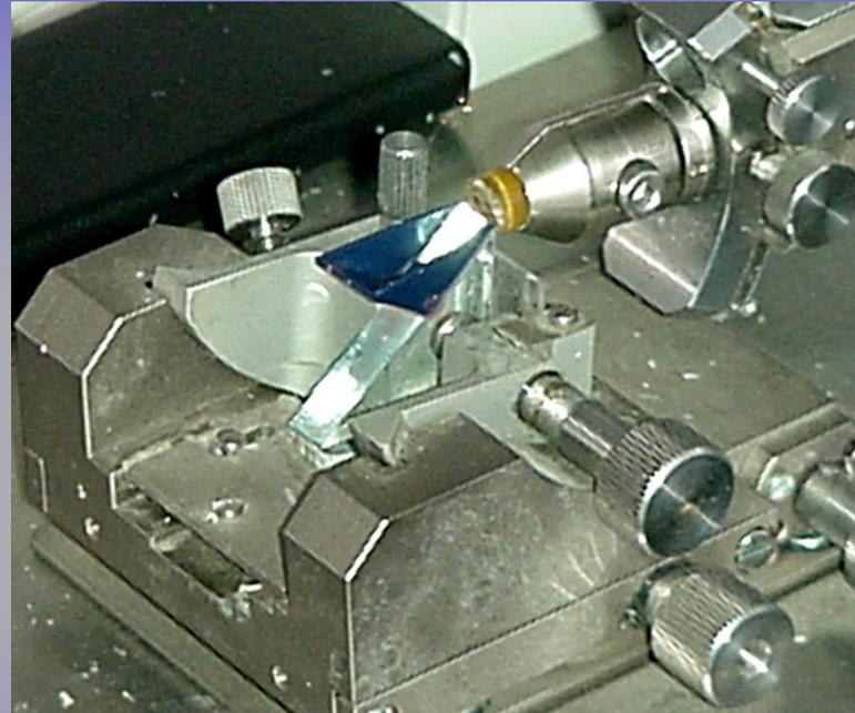
Le sezioni ultrafini ottenute con gli ultramicrotomi non possono essere maneggiate per la loro estrema fragilità e per le ridotte dimensioni; inoltre non possono essere poste su un supporto di vetro che arresterebbe il fascio elettronico. La sezione è ottenuta sfruttando il filo di una **lama di cristallo o diamante** che seziona il campione contenuto in una dura resina acrilica o epossidica.
