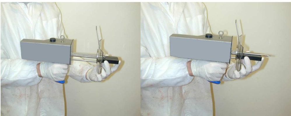
Verifica taratura strumento con test block
